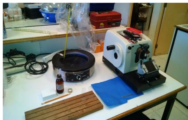
**Figura 4** Equipamiento para el corte histológico y el montaje de los cortes de la piel y del ovario de los animales utilizados en los experimentos
