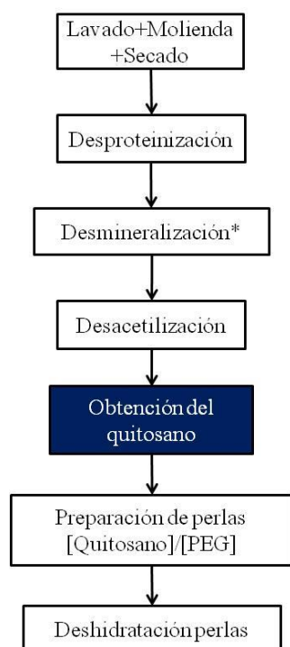
Figura 2 Diagrama de flujo del proceso de obtención de perlas a base de quitosano. El lavado, molienda y secado corresponde a la materia prima (cáscaras de camarón)
